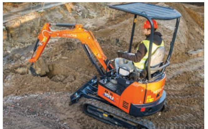
La version avec toit à trois montants améliore la visibilité.
