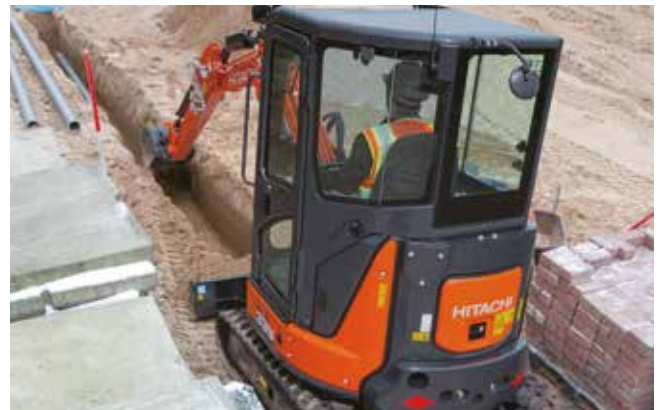
Grâce à son rayon de rotation arrière court, la ZX33U-6 convient parfaitement aux travaux dans les espaces réduits.
