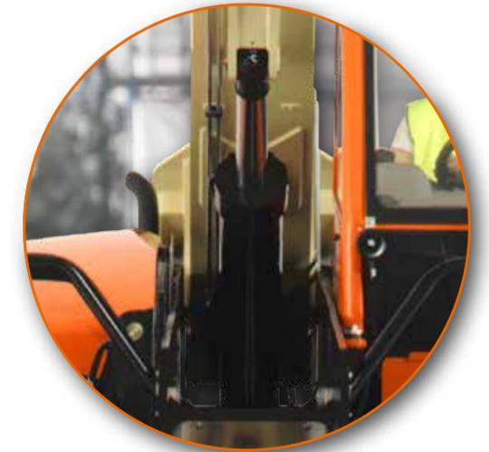
En outre, ces modèles permettent d'alléger l'entretien tout en réduisant le nombre potentiel de points de fuite hydraulique grâce à un vérin unique pour la compensation et le levage.
