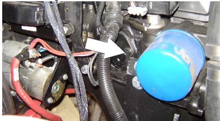
Point(s) de lubrification - Bouchon de remplissage/élément vissable (JLG N/P 7027965)
