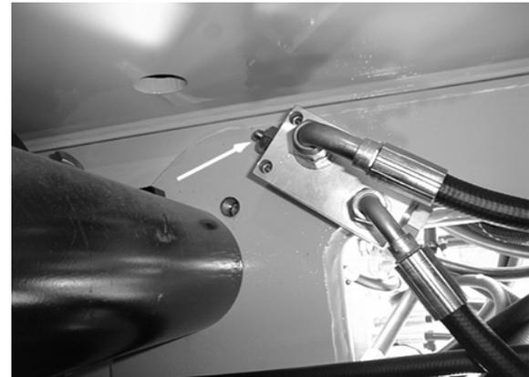
Figure 2-7. Contacteur de fin de course verticale de la flèche de tourelle
